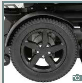
EA 010 Garde-boue roues motrices
