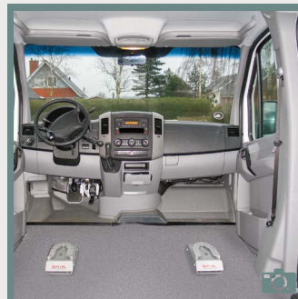
ES 013 Préparation pour système d'arrimage DAHL
