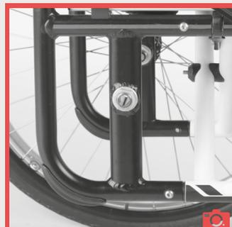
MA 114 Palier de roues arrière soudé
