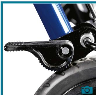
Système anti-recul sur roues arrière
