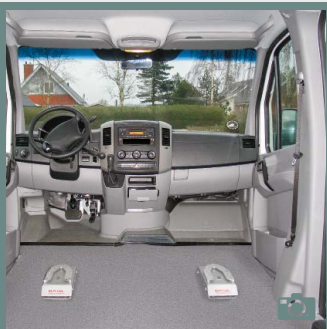
ES 013 Préparation pour système d'arrimage DAHL
