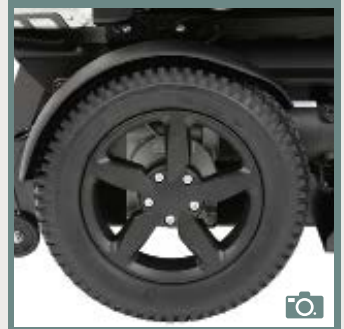
EA 010 Garde-boue roues motrices
